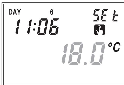
Das Feld **(17)** verschwindet. Im Feld **(16)** blinkt der Wert der manuell eingestellten Temperatur.
