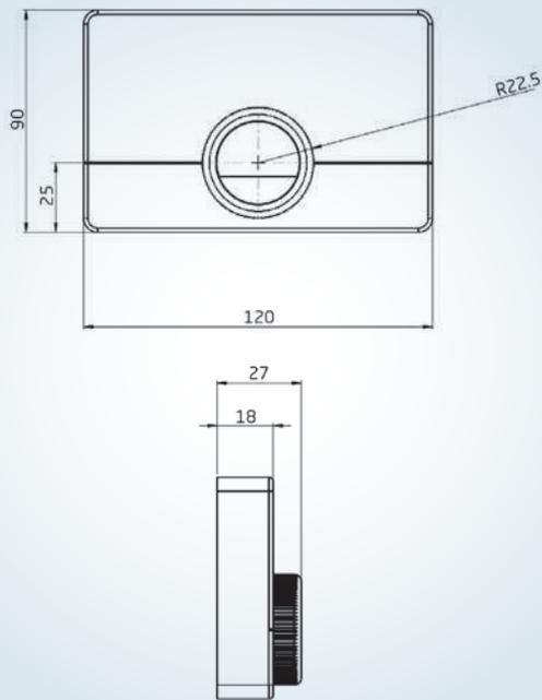
Die Abmessungen von Baxi Mago wurden so konzipiert, dass der Schaltschrank 503 abgedeckt ist.
